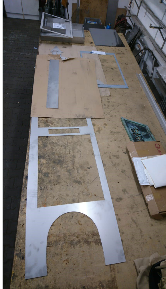
Noch liegen die Einzelteile der zukünftigen Plakatvitrine auf der Werkbank in der Schlosserei.
